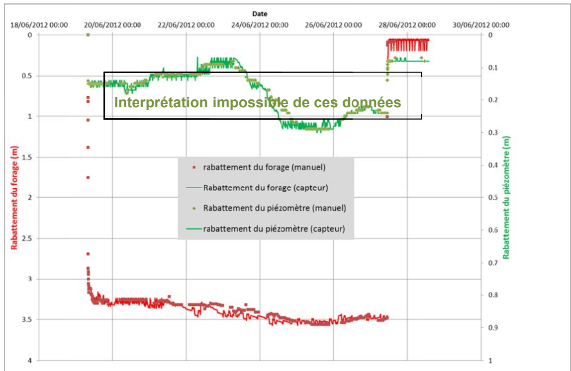
Illustration 23 : Rabattements du piézomètre et du forage pendant le pompage d'essai longue durée calculés à partir des données manuelles et des données enregistrées par les capteurs.
