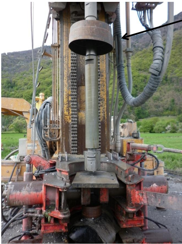
Seau servant pour la récupération des cuttings
